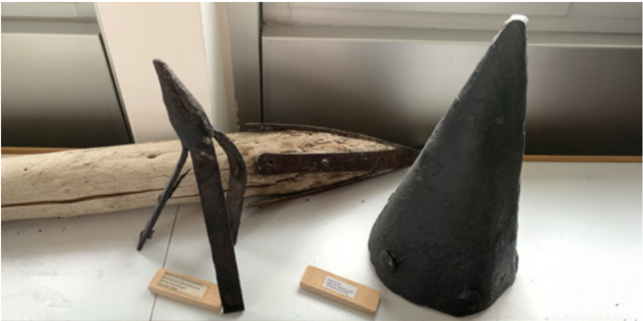
▲ AfU UH 24.2.2025: Pfahlschuhe von der Emme und der Aare; ca. von 1880
